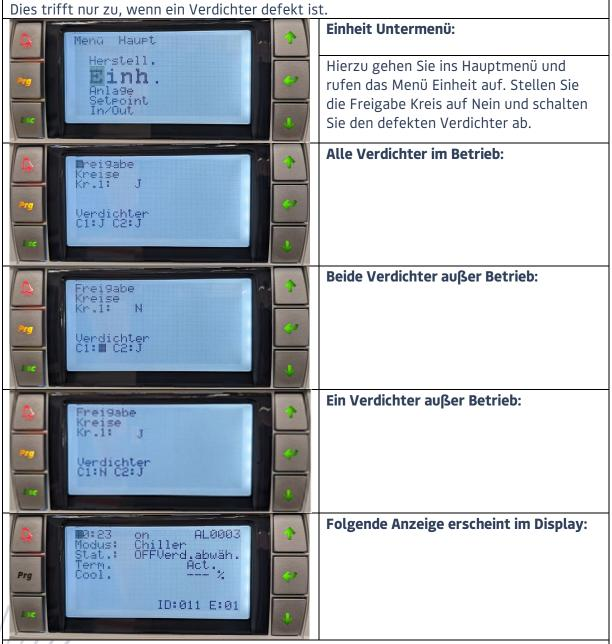
Im Normalbetrieb findet ein Betriebsstundenausgleich der Verdichter statt. Die Verdichter schalten abwechselnd zu, um einen erhöten Verschleiß eines einzelnen Verdichters zu vermeiden.
